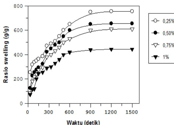
Gambar 2. Kinetika *swelling* hidrogel poli(kalium akrilat)-g-glukomanan dalam air suling dengan beragam konsentrasi glukomanan hasil iradiasi 10 kGy diukur pada suhu kamar.
