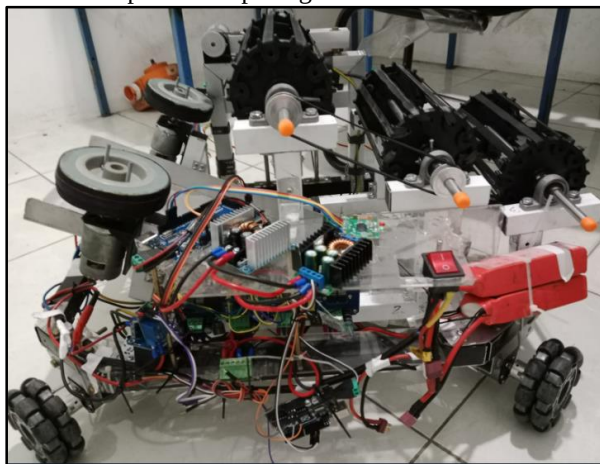
Gambar 7. Sistem Kelistrikan Robot dan Bluetooth Receiver pada Rangka Kiri Robot
