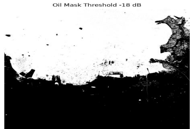
Gambar 9. Hasil deteksi oil spill menggunakan threshold -18 dB. Area putih menunjukkan kandidat oil spill dan area hitam menunjukkan non-oil spill .
