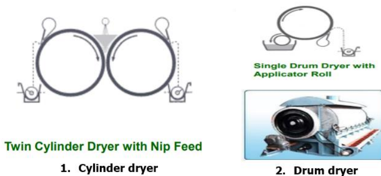
Gambar 41. Pengeringan tidak langsung tipe kontinyu (Sumber: www.fertilizer-machine.net/product/rotary-drum-drying-machine.html )
