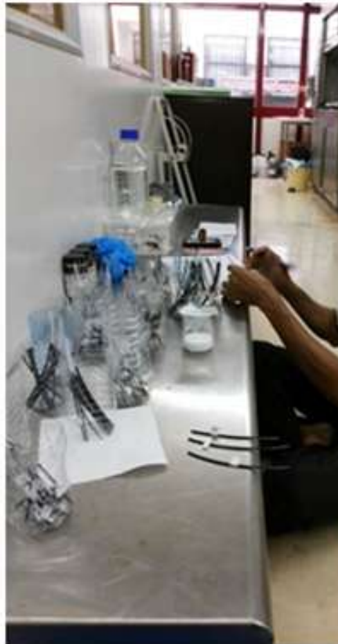
Rajah 2.13 Proses pelapisan pada kuar gentian optik plastik
