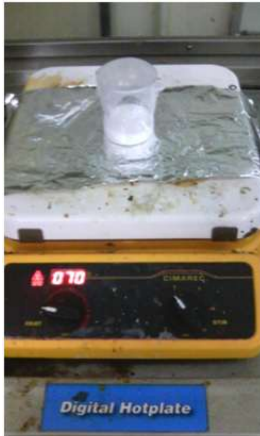
Rajah 2.12 Proses pengkacau bahan Zink Oksid dengan cecair Methanol
