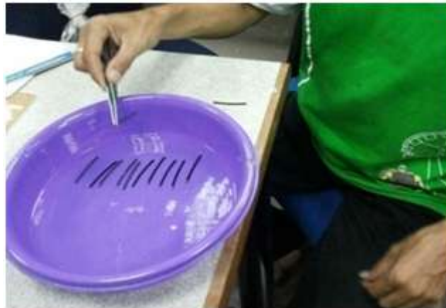
Rajah 2.9 Proses punaran dengan menggunakan Asetondi dalam sebuah bekas
