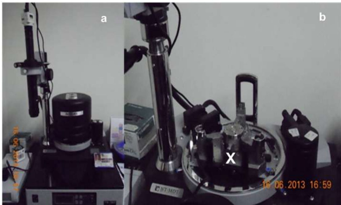
Rajah 5.10 NTEGRA AURA mikroskop kuar pengimbas, (a) Tampak hadapan, dan (b). Tempat meletakkan bahan sampel ZnO
