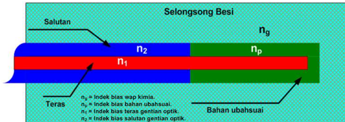
Rajah 3.7 Bentuk terperinci daripada hujung pengesan
