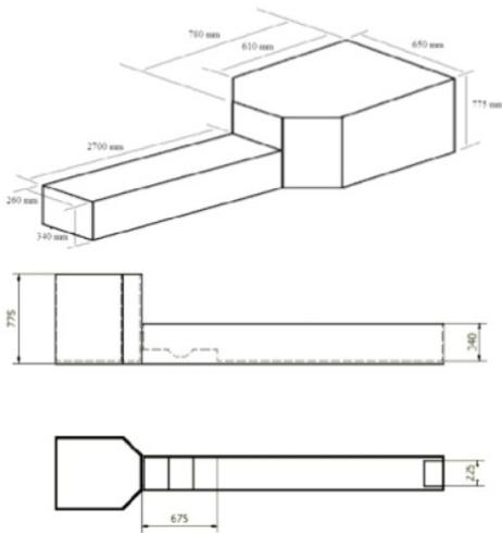
Gambar 5 Geometri bangunan air
