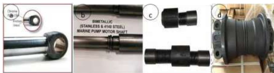
Gambar 2-3 Aplikasi pengelasan gesek dengan metode pengelasan gesek rotary
