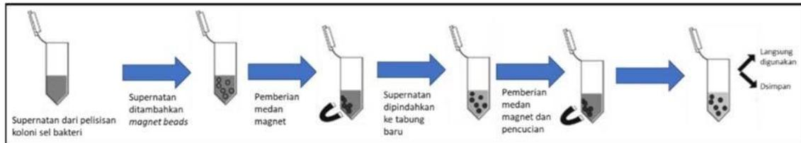
**Gambar 4.** Skematik ekstraksi DNA dari sel bakteri menggunakan metode magnet beads.
