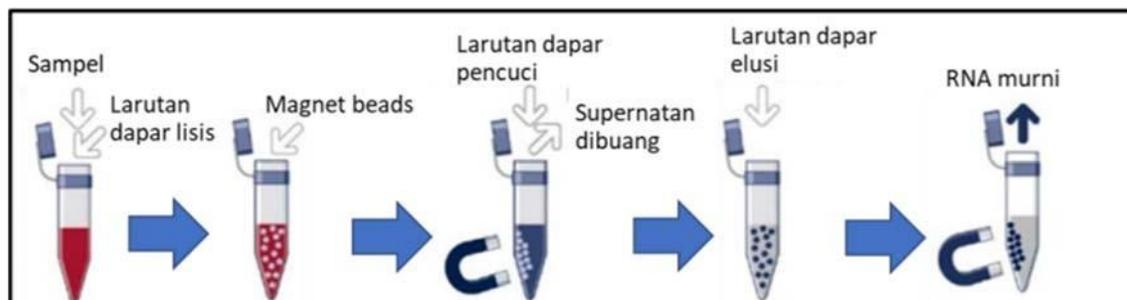
**Gambar 12.** Skematik isolasi RNA menggunakan metode magnet beads.
