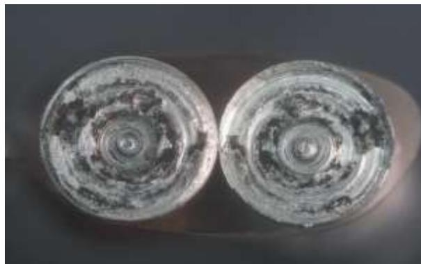
*Gambar 4. 12 Struktur makro pada rpm 2000*
