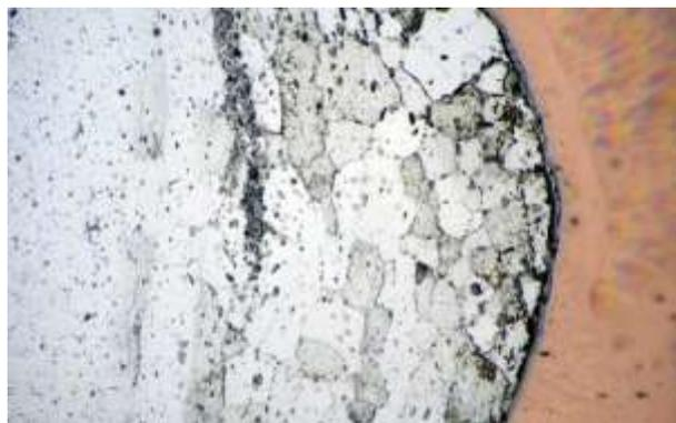
*Gambar 4. 10 Struktur mikro daerah pengelasan dengan perbesaran 500x*
