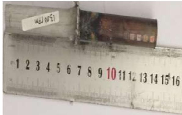
Gambar 4. 2 aluminium dan tembaga setelah di friction welding
