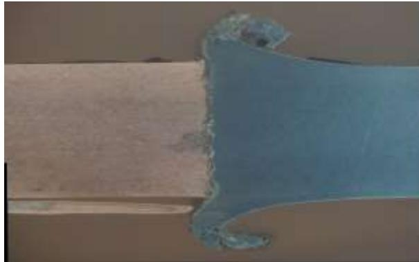
Gambar 4. 4 Struktur makro pada rpm 1000
