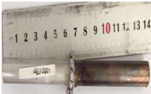
Gambar 4. 1 aluminium dan tembaga setelah di friction welding
