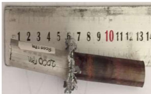
Gambar 4. 3 aluminium dan tembaga setelah di friction welding
