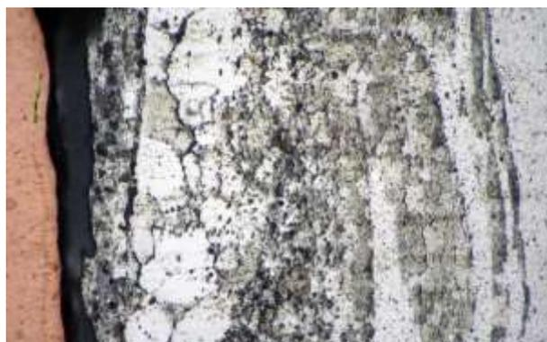
*Gambar 4. 14 Struktur mikro daerah pengelasan dengan perbesaran 500x*
