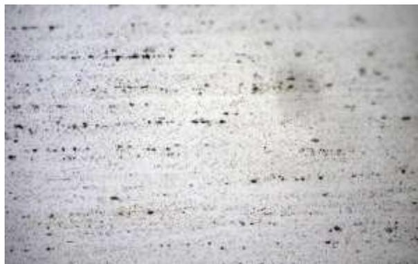
Gambar 4. 5 Struktur mikro aluminium dengan perbesaran 100x
