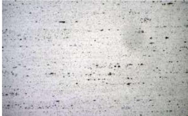
*Gambar 4. 13 Struktur mikro aluminium dengan perbesaran 100x*
