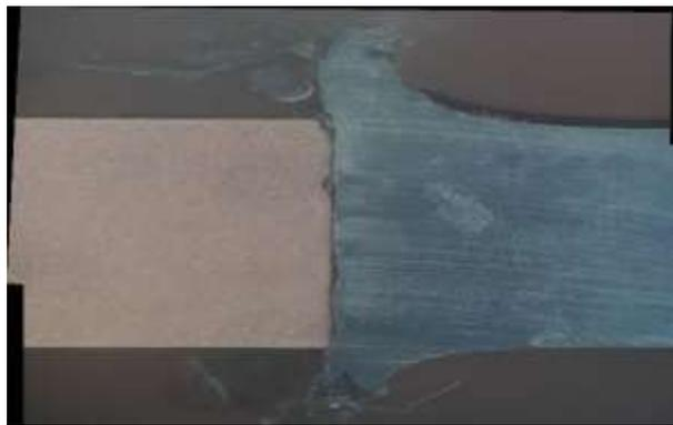
Gambar 4. 8 Struktur makro pada rpm 1300
