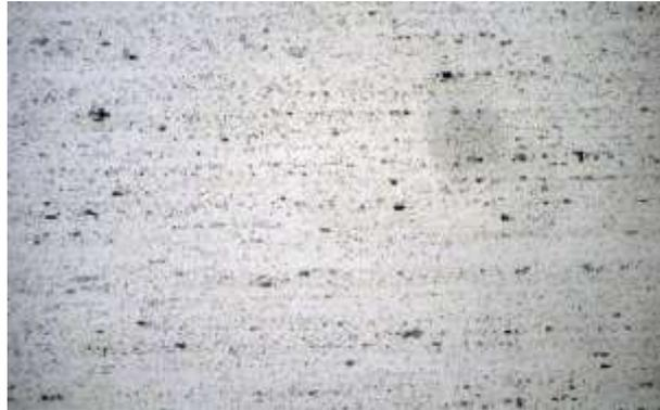
*Gambar 4. 9 Struktur mikro aluminium dengan perbesaran 100x*
