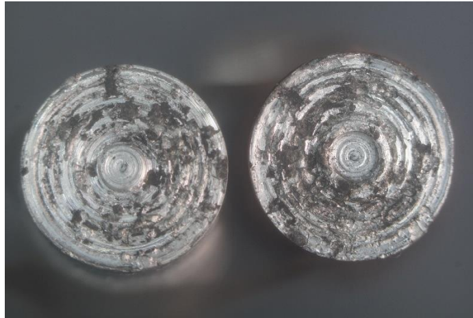
Gambar 4. 6 Gambar patahan uji tarik variasi 1000 RPM
