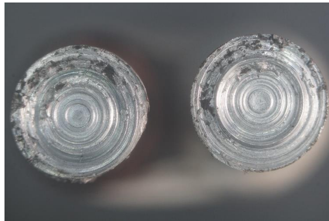
Gambar 4. 8 Gambar patahan uji tarik variasi 1300 RPM
