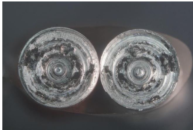
Gambar 4. 10 Gambar patahan uji tarik variasi 2000 RPM
