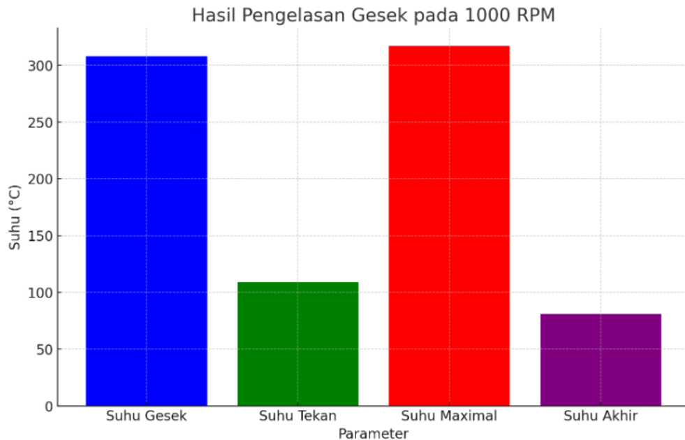
Gambar 4. 2 Gambar Grafik Suhu Variasi 1000 RPM
