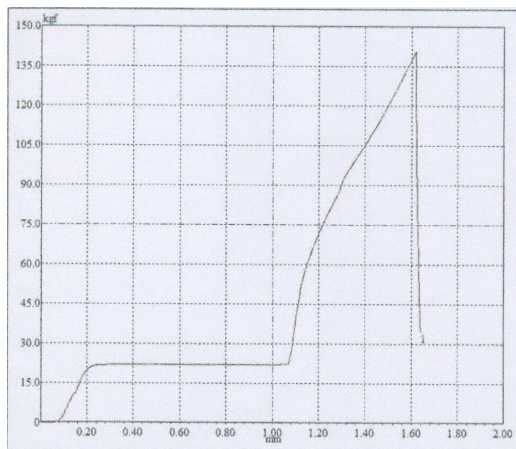
Gambar 4. 9 Grafik hasil uji tarik variasi 2000 rpm
