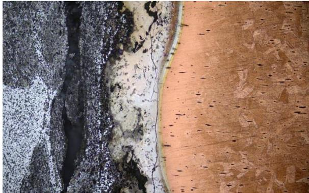
**Gambar 4. 7** Struktur Mikro Daerah Pengelasan (Perbesaran 500x)
