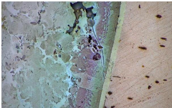
**Gambar 4. 15** Struktur Mikro Daerah Pengelasan Variasi 40 kg (Perbesaran 500x)
