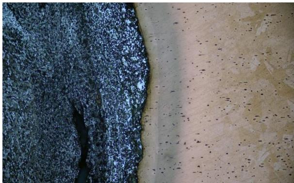
**Gambar 4. 11** Struktur Mikro Daerah Pengelasan (Perbesaran 500x)
