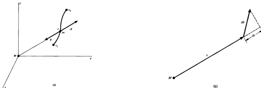
Gambar 6.3 Diagram untuk mencari pekerjaan yang diperlukan untuk memindahkan tes partikel di Medan gravitasi.
