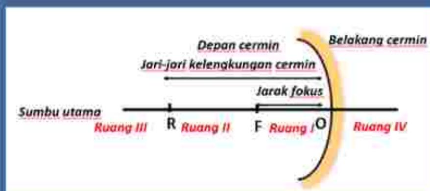
Gambar 106. Bagian-Bagian Cermin Cekung
