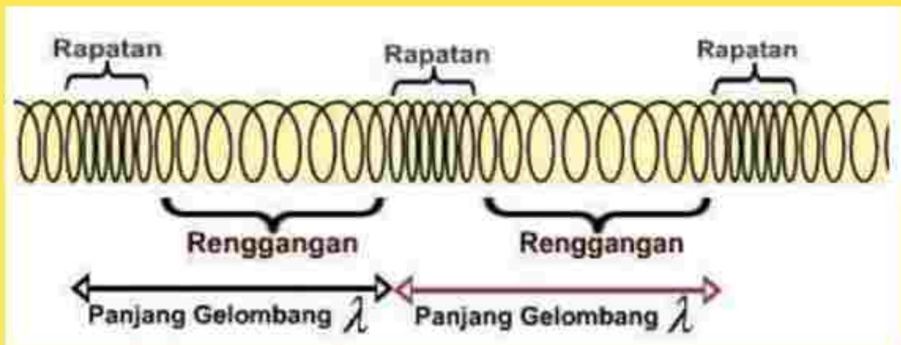
Gambar 96. Panjang Gelombang Longitudinal
