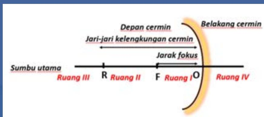
Gambar 106. Bagian-Bagian Cermin Cekung
