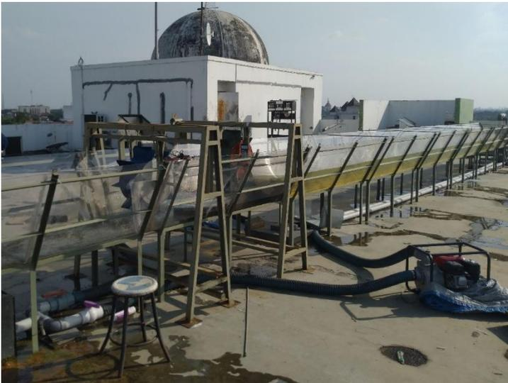
Gambar 20 Saluran terbuka tempat pengujian kincir seri
