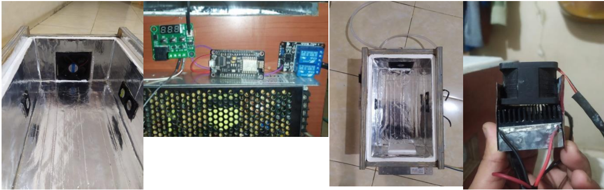
Gambar 4-2 bagian dalam, pendingin, dan sisi kanan box pendingin
