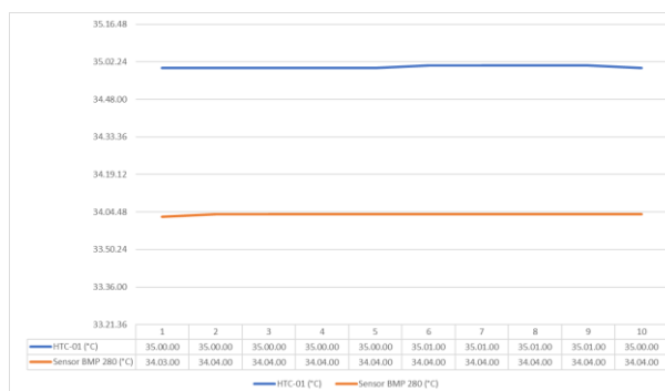
Gambar 4- 5. Grafik Pembacaan Sensor BMP280 dan HTC-01 di Dataran Rendah (Sumber : Dokumentasi Pribadi)
