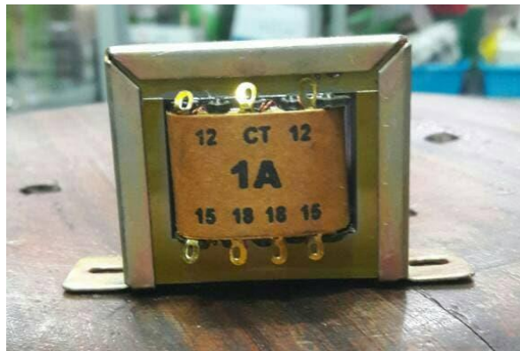
Gambar 2-10. Trafo CT 1A
