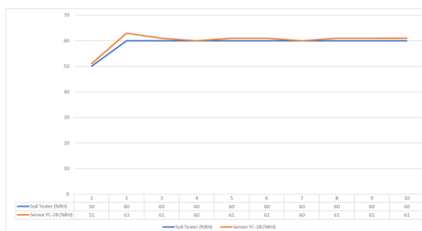
Gambar 4- 7. Grafik Pembacaan Sensor FC-28 dan Soil Tester di Dataran Tinggi (Sumber : Dokumentasi Pribadi)
