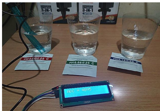
Gambar 4.9 Mencari nilai ADC pada pH
