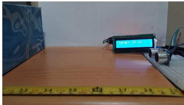
Gambar 4.7 Proses perbandingan pengukuran sensor ultrasonik dengan meteran
