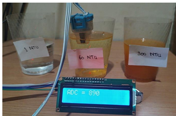
Gambar 4.5 Mencari nilai ADC pada sampel air
