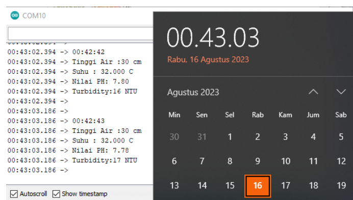
Gambar 4.1 Perbandingan waktu RTC dengan jam digital
