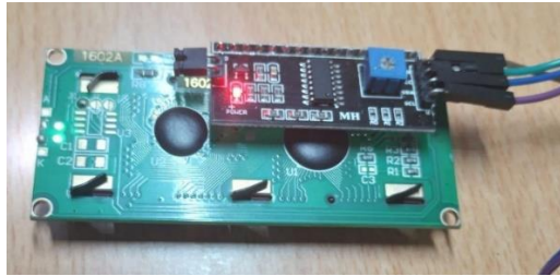
Gambar 4.2 Tampilan I2C menyala saat mendapatkan tegangan
