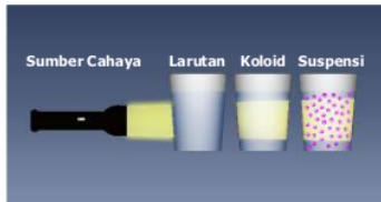
Gambar 1.10. Peristiwa Efek Tyndall, cahaya diteruskan melalui larutan (kiri) tetapi dihamburkan oleh sistem koloid \text{Fe}_2\text{O}_3 (kanan).
