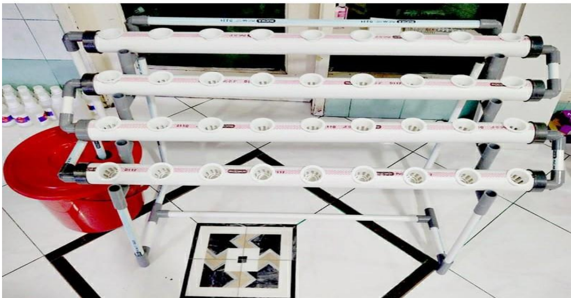
Dokumentasi hasil perakitan Hidroponik sistem NFT (Nutrient film technique)
