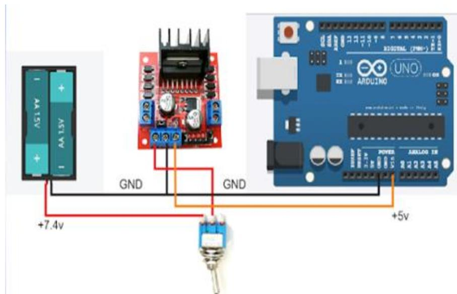
**Gambar3.** *Hubungan kabel robot mobile*
