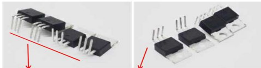
Tekuk 90° kaki IRF640 terlebih dahulu seperti gambar (2 kearah bawah 2 kearah atas)
