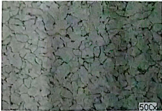
Gambar 19 Struktur mikro daerah HAZ berupa butir halus ferit-perlit
