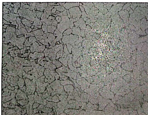
Gambar 15 Struktur mikro daerah HAZ berupa butir halus ferit-perlit
