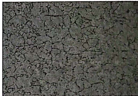
Gambar 17 Struktur mikro daerah HAZ berupa butir halus ferit-perlit
