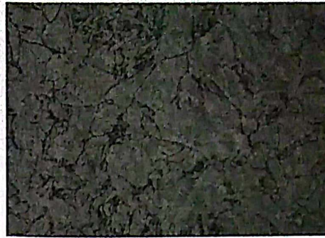
Gambar 16 Struktur mikro daerah material las (WM) berupa ferit-bainit
