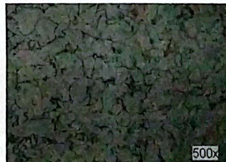
Gambar 24 Struktur mikro daerah material las (WM) berupa ferit-bainit
