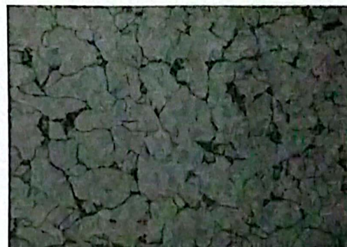
Gambar 23 Struktur mikro daerah HAZ Berupa butir halus ferit-perlit
