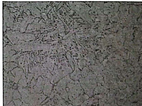
Gambar 18 Struktur mikro daerah material las (WM) berupa ferit-bainit
