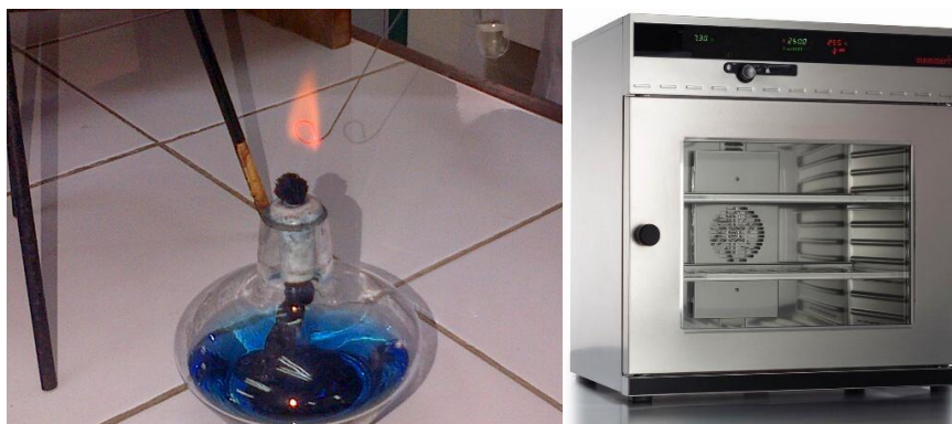
Gambar 17. Sterilisasi Pemijaran (kiri) dan Sterilisasi Panas Kering (kanan)
