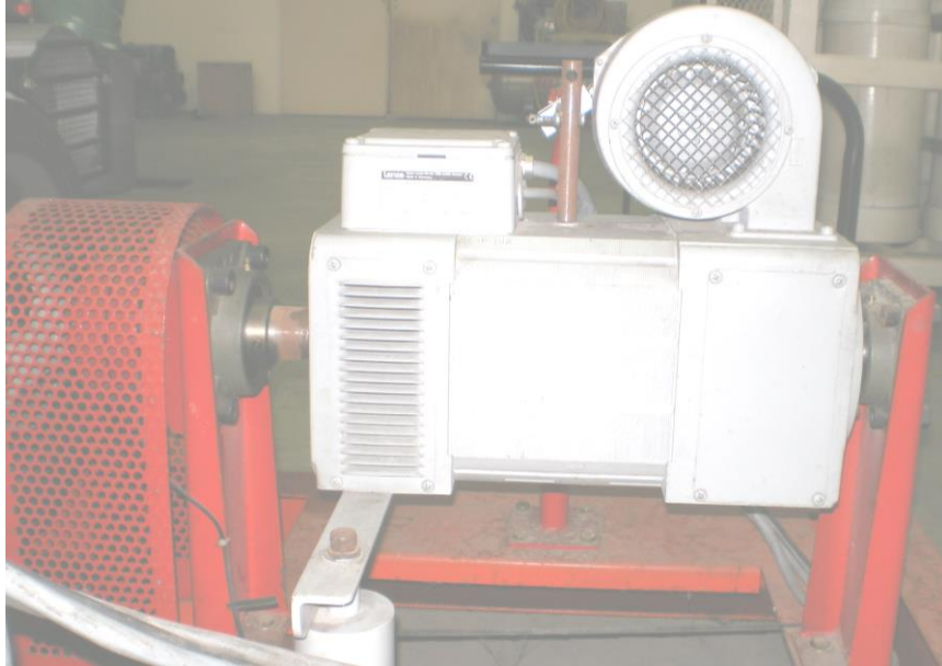
Rajah 4.3 Gambar Dinamometer Lenze jenis MGFQU 100-22
