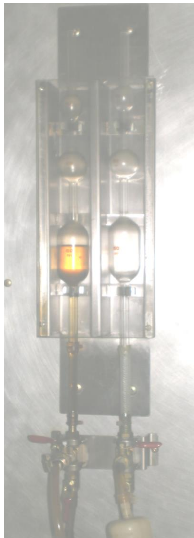
Rajah 4.8 Gambar glass buret pengatur halaju bahan api
