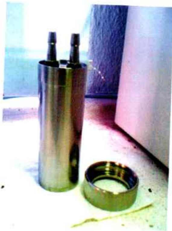
Rajah 3.17 tetabung yang di gunakan pada rheometer haake
