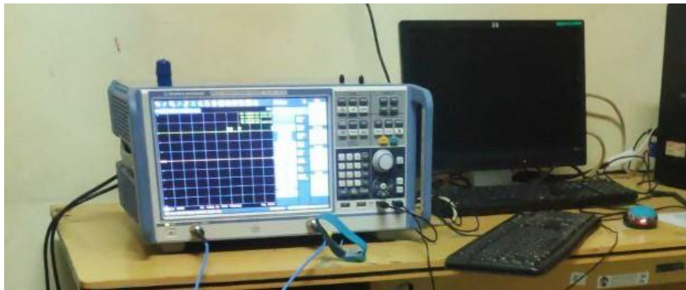
gambar 4.16 Pengujian Antena dengan Network analyzer
