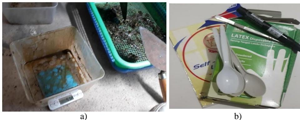
**Gambar 4. 2 Penyiapan Alat: a) Timbangan digital, wadah, saringan, sendok pengaduk. b) Sarung tangan, pinset, lebel kertas, spidol, sendok plastik**
