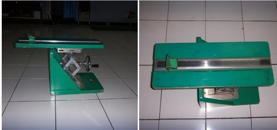
**Gambar 3.1** : Alat ukur Sit dan Reach Test
