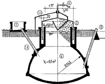
Gambar 5. Digester tipe floating drum (sasse 1984)
