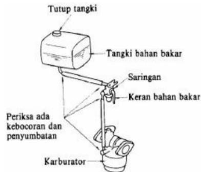
Gambar 3 Komponen sistem bahan bakar motor sederhana.
