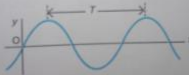
Gambar 7.18 Pada grafik hubungan antara pergeseran partikel dan waktu tempuhnya, jarak dua puncak berurutan merupakan periode gelombang ( T ).
