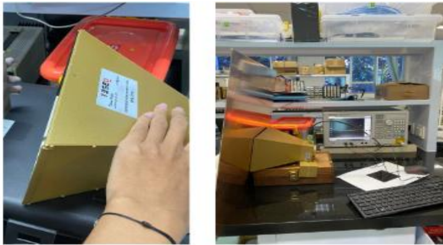
Gambar 4.18 Pengukuran Menggunakan Horn Antena dan Pengukuran Menggunakan Horn Antena + Reflektor
