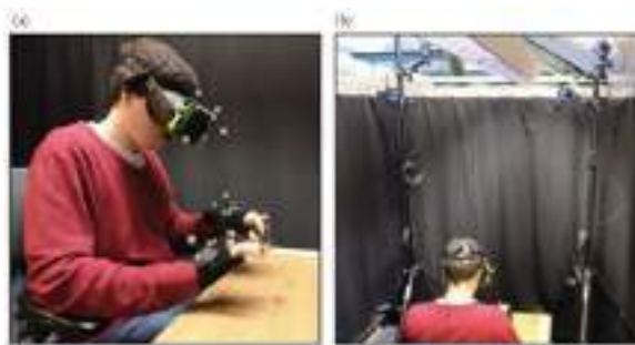
Gambar 5.15. Contoh penggunaan penanda optik untuk mengukur gerakan tangan pengguna saat mengetik di udara
