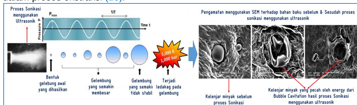
Gambar D.3: Prinsip kerja dan aplikasi penggunaan ultrasonik (26,27)
