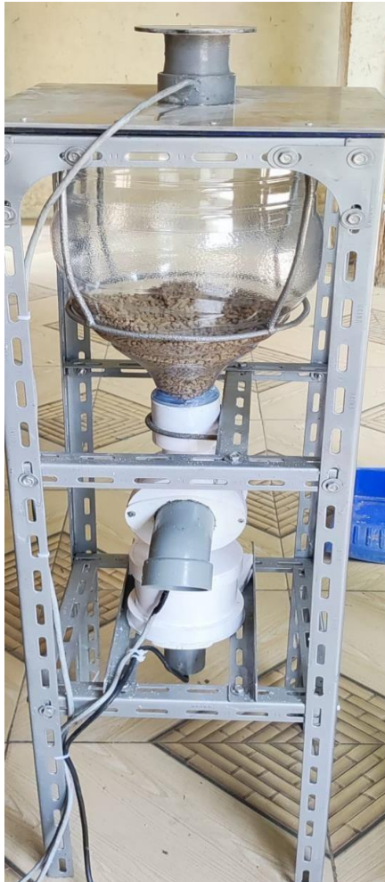
Gambar 5. Alat pemberian pakan ikan otomatis (Fish Feeder)
