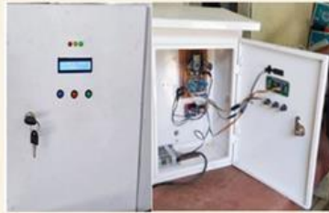
Gambar 2. Box control rakitan sebagai control pakan ikan otomatis setting waktu pelepasan pakan ikan dan jumlah volume pakan yang akan disebar ke kolam
