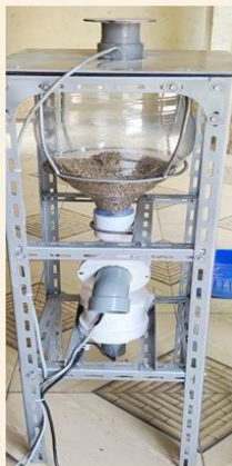
Gambar 1. Rakitan sendiri Alat pemberian pakan ikan otomatis (Fish Feeder)
