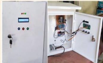
Gambar 2. Box control rakitan sebagai control pakan ikan otomatis setting waktu pelepasan pakan ikan dan jumlah volume pakan yang akan disebar ke kolam
