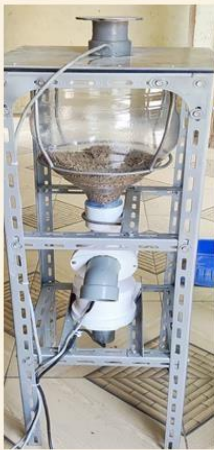
Gambar 1. Rakitan sendiri Alat pemberian pakan ikan otomatis (Fish Feeder)
