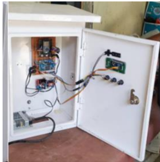
Gambar 6. Box control, sebagai control pakan ikan otomatis setting waktu pelepasan pakan ikan dan jumlah volume pakan yang akan disebar ke kolam
