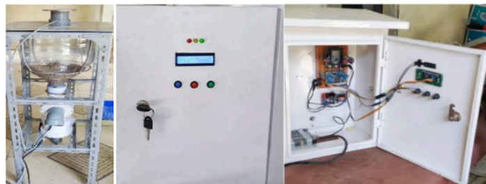
Gambar 5. Alat pelontar pakan ikan otomatis
