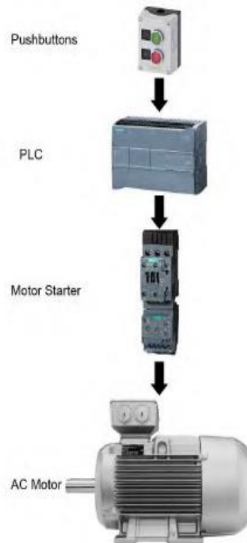
Gambar 4 Cara Kerja Sederhana PLC
