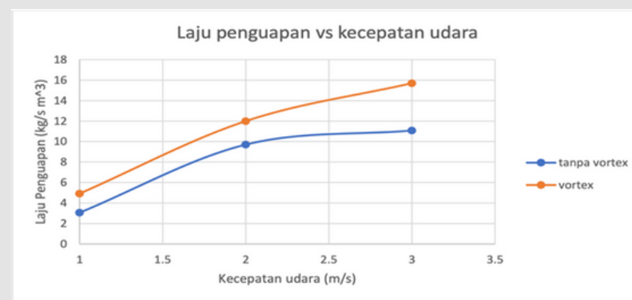
Gambar Grafik Laju penguapan terhadap kecepatan udara
