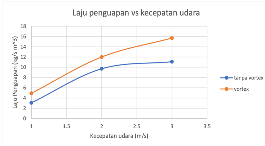
Gambar 5. Grafik Laju penguapan terhadap kecepatan udara
