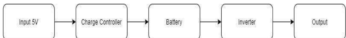
Gambar 4 : sistem pembangkitan lampu emergensi.
