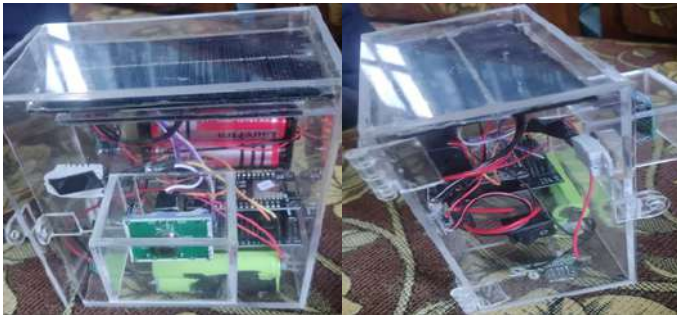
Gambar 30. Prototype Alat Monitoring Berbasis Internet of Things (IoT) yang Dilengkapi dengan Panel Surya
