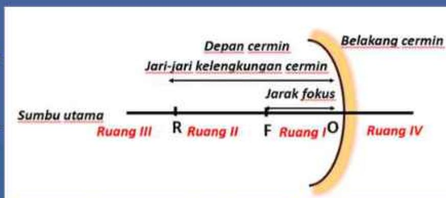
Gambar 106. Bagian-Bagian Cermin Cekung
