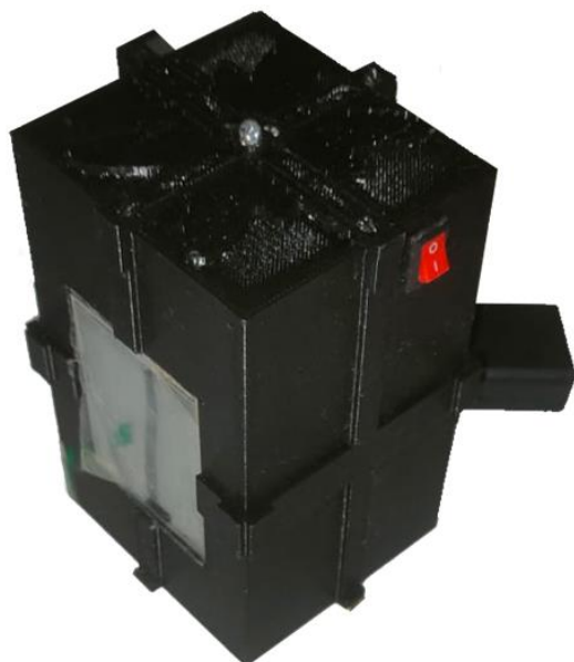
Gambar 7. Tampak luar alat monitoring suhu ruang server yang sudah berhasil dirancang.
