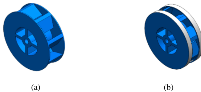
Gambar 1. (a) Kincir air terbuka dan (b) Kincir air tertutup
