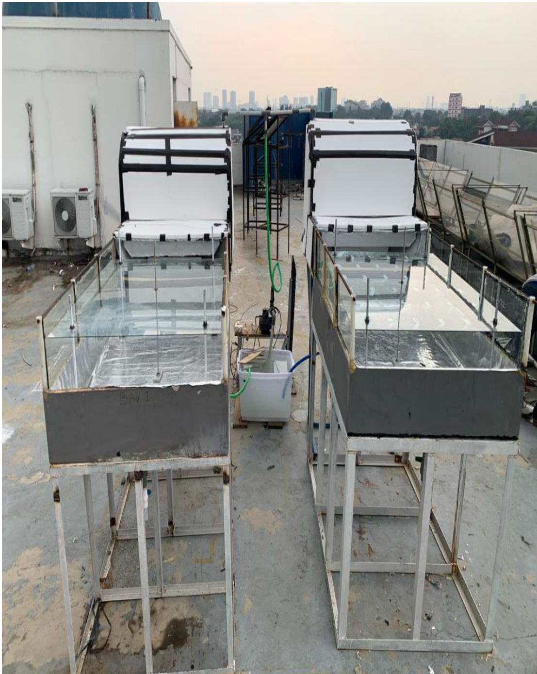
Gambar 6. Kolam Pemekatan Tanpa Vortex dan Menggunakan Vortex Generator
