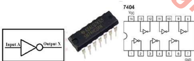
Gambar 5.3 Simbol gerbang NOT (NOT Gate), Komponen IC NOT, dan rangkaian dalam digitalnya.
