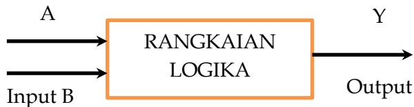
Gambar 5.2 Diagram blok rangkaian logika dengan dua variable input
