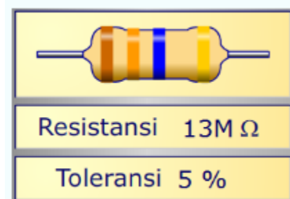
Gambar 4. Tabel Kode warna dan cara membaca nilai resistor
