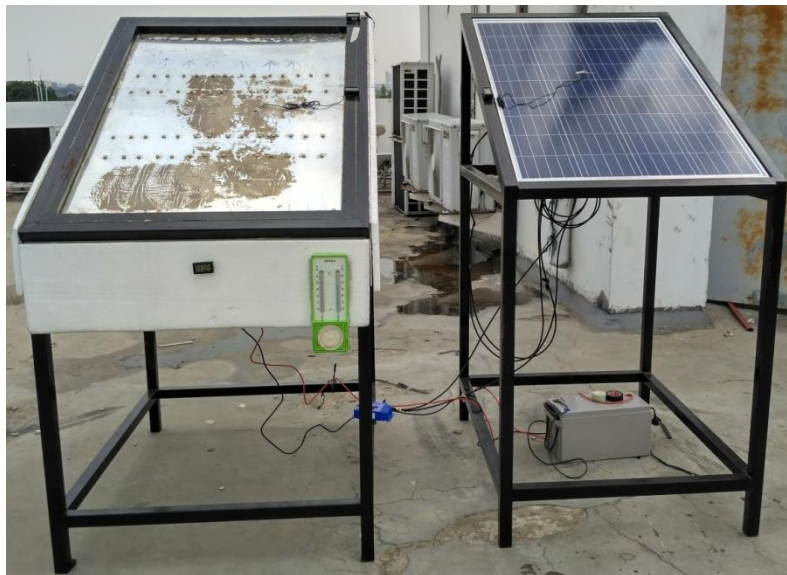
Gambar 4.1 Alat penelitian sistem pendingin termoelektrik bertenaga sel surya a. Sebelah kiri adalah sistem pendingin termoelektrik b. Sebelah kanan adalah sel surya
