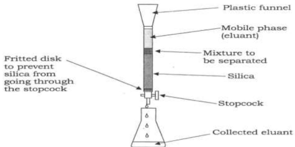
Skema alat kromatografi kolom
